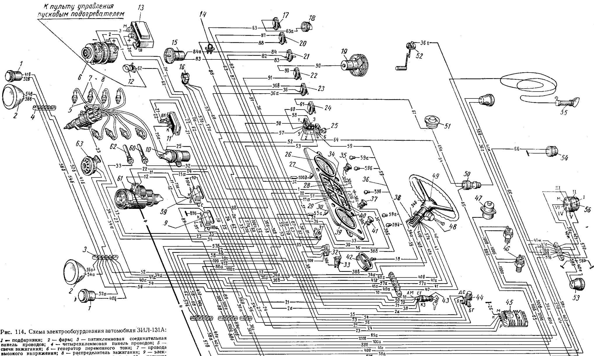
Рис. 114. Схема электрооборудования автомобиля ЗИЛ-131А:
